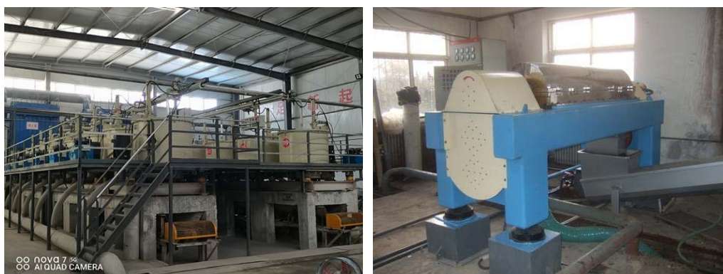
上面两个图片中的机器都安装了减振器
